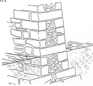
COUPE SCHEMATIQUE DU DRAINAGE D'UN MUR DE SOUTÈNEMENT
